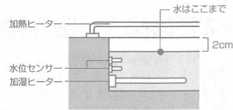
※水位センサーと水槽は常に清掃してください。清掃の際は全てのスイッチを切にしてください。
