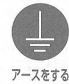
アース工事を確実に行ってください。アース線は、ガス管、水道管、避雷針、電話のアース線に接続しないでください。アースが不完全な場合は、感電の原因になります。
